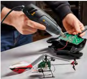
Soldadura de componentes eléctricos
