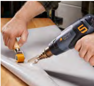
Reparación de lona
